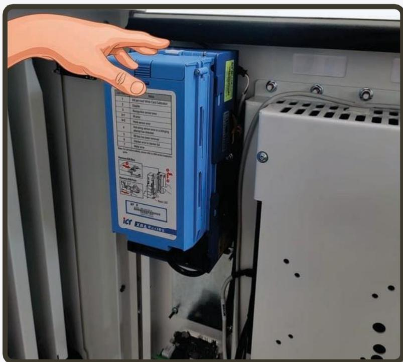
Per ritirare le banconote incassate, basta staccare lo stacker tirando la levetta bianca posta in alto e sollevandolo, una volta smontato sarà sufficiente aprire lo sportello superiore dello stacker per raccogliere le banconote.
